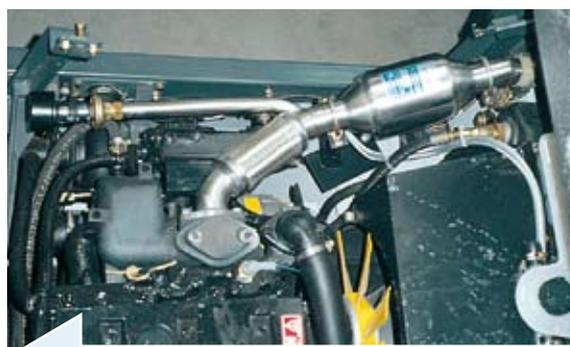
La durata del catalizzatore OSCA è indicativamente 10.000 ore di funzionamento. Nei motori a CICLO OTTO (GAS e BENZINA) i gas di scarico non contengono ossigeno sufficiente per l'efficace funzionamento del catalizzatore.
